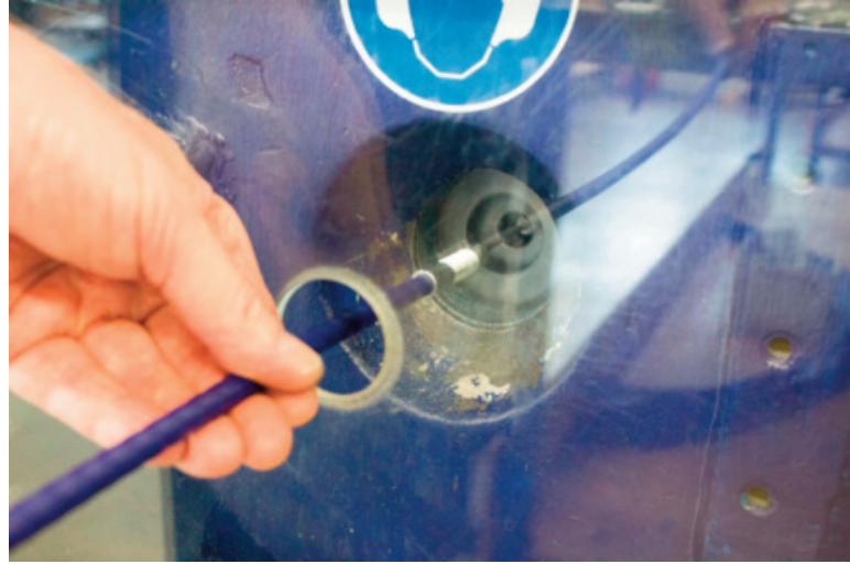
Rotationspressen von Schlauchhülsen: Auch dem Verpressen der Endteile seiner Druck-Zug-Kabel widmet RINGSPANN RCS große Aufmerksamkeit. Für jeden Kabeltyp kommt stets eine optimierte Pressausführung zum Einsatz.
